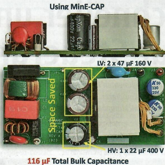
Bild 2: Gegenüber dem Ausgangsdesign (links) benötigen die Zwischenkreiskondensatoren bei dem Design mit MinE-CAP (rechts) deutlich weniger Platz.
