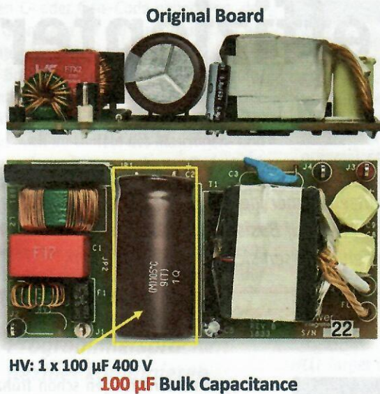
Bild 2: Gegenüber dem Ausgangsdesign (links) benötigen die Zwischenkreiskondensatoren bei dem Design mit MinE-CAP (rechts) deutlich weniger Platz.
